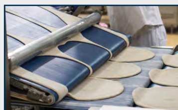
5. Restteigrückführung: der restteig wird zum Teigbandformer zurücktransportiert. Dies bringt unsere Pizza Bodenlinie auf ein höchst effektives und kostensparendes Niveau.
