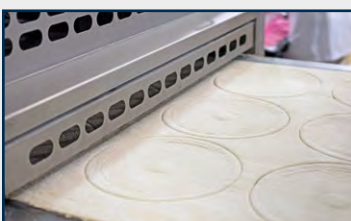
4. Produktschneiden: Schneiden von Produkten aus den Teigbändern. Verschiedene Formen und Größen sind möglich.
