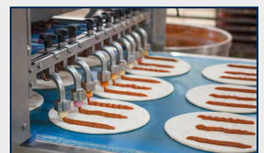
5. Auftragen der Sauce: Die Tomatensauce wird auf den Pizzaboden aufgetragen. Hierbei gibt es zwei Verfahren: die Duschkopfauftragung und die Streifenauftragung.
