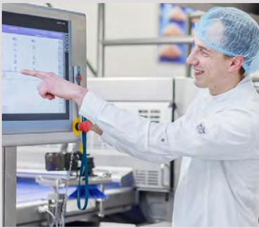
Die Bedienoberfläche des 22-Zoll-Touchscreens ist sehr übersichtlich gestaltet. Seine Position lässt sich mühelos auf die bevorzugte Arbeitshöhe einstellen. Die Steuerungsplattform ermöglicht einen nahtlosen OMAC-basierten Datenaustausch mit benachbarten Geräten von Drittanbietern. Die fortschrittliche Datenverarbeitung ermöglicht eine Echtzeitüberwachung und Feinabstimmung der Anlageneffizienz.
