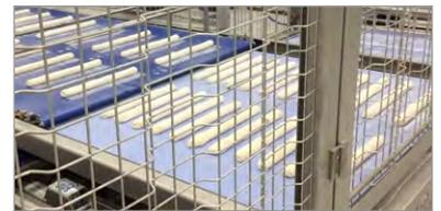
Die Produkt-Absetzsysteme beladen die darunter positionierten Gärdielen, Backbleche, Backformen, oder Transportbänder. Wir haben mehrere Systeme entwickelt, um für jede spezifische Situation eine Lösung zu bieten.
