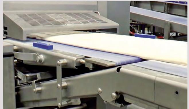
*Eliminierung von Fallhöhen: Die Minimierung der Transporthöhe entlang der Produktionslinie führt zu einem stabilen und entspannten Teigband.*
