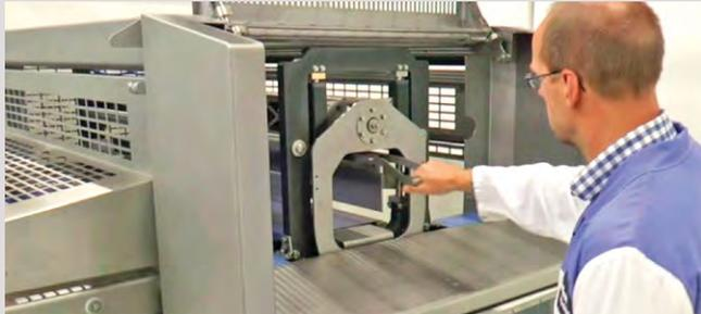
*Effizienter, fehlerfreier Betrieb und Werkzeugwechsel werden durch den Einsatz von UniqueFit Tooling erreicht. Die leichten und kompakten Werkzeuge machen die Handhabung und den Werkzeugwechsel so einfach wie möglich und können von einer Person durchgeführt werden. Es sind keine zusätzlichen Vorrichtungen zur Unterstützung des Bedieners beim Werkzeugwechsel erforderlich.*
