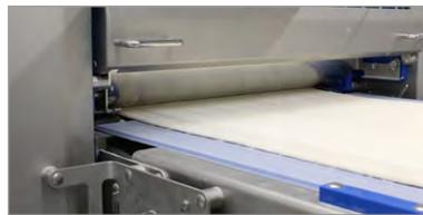
4. Das Teigband wird während des Durchlaufs durch die Walzen des Schichtwerks statt auf seine endgültige Dicke reduziert.
