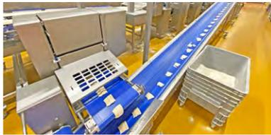
Option: Über das Inline-Teigrecycling-System wird der aufbereitete Teig direkt in den Vorschneider zurückgeführt. Auf diese Weise geht kein Teig während des Produktionsprozesses verloren.
