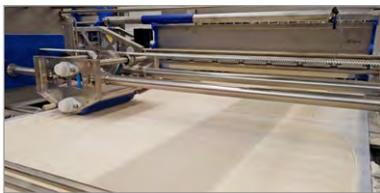
3. Das Querwalzwerk reduziert die Dicke des Teigbandes und vergrößert seine Breite. Es kompensiert die einseitige Reduzierung der Reduzierstationen.
