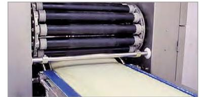
2 Die erste Reduzierung des Teigbandes erfolgt durch einen Quick-Reduzierer. Einzigartige Antihaftrollen ermöglichen die Verarbeitung von Teigen mit hohem Wassergehalt.
