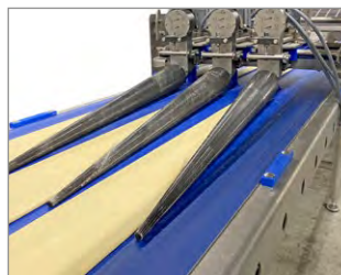
3 Produktformung. Dieses Beispiel zeigt die Schneckenwickler. Auf der rechten Seite finden Sie die verschiedenen Möglichkeiten der Formgebung.
