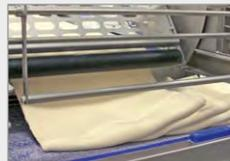
3. Laminierung: um eine feinere und gleichmäßigere Zellstruktur und eine höhere Gärstabilität zu erhalten.
