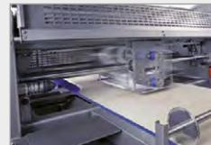
4. Querwalzwerk: um die einseitige Reduzierung der Reduzierstationen auszugleichen und die Dicke des Teigbandes anzupassen. Das Teigband verliert an Dicke und nimmt an Breite zu.
