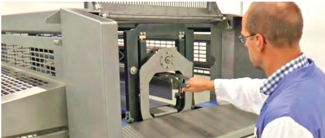
Mit dem Unique Fit Tooling werden ein effizienter, fehlerfreier Betrieb und Werkzeugwechsel sichergestellt. Dank der leichten und kompakten Werkzeuge ist die Handhabung und Demontage der Werkzeuge äußerst einfach und kann von einer Person durchgeführt werden. Der Bediener benötigt keine weiteren Vorrichtungen, um die Werkzeuge zu wechseln.
