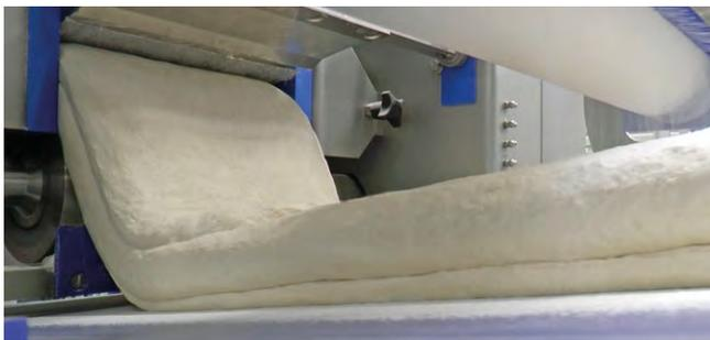
*Eliminierung von Fallhöhen: Durch die Minimierung der Transporthöhe in der gesamten Produktionslinie ergibt sich ein stabiles und spannungsfreies Teigband.*
