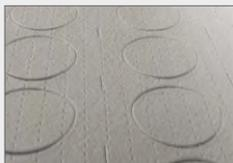
6. Dekorierstation: stellt sicher, dass die Produkte ihre typische Oberfläche entfalten und beim Backen keine Blasen auf der Produktoberfläche entstehen.
