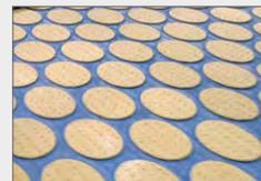
9. Belegstation: ein Modul zum Belegen der Backwaren mit Samen, z. B. mit Sesam oder anderen Samen; kann ebenfalls in die Anlage integriert werden
