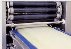
2. Quickreduktor-Schlichtwerk: Die erste Reduzierung der Teigbandstärke erfolgt mit Hilfe eines Quickreduktor-Schlichtwerkes. Dank unserer einzigartigen Antihafrollen sind wir in der Lage, Teigsorten mit hohem Wasseranteil zu verarbeiten.
