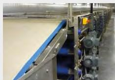
7. Ausstechstation: Die Produkte werden mit einer rotierenden oder einer Schneidemaschine aus dem Teigband geschnitten.
