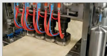
7. Die **servogesteuerte Crimp-Einheit** versiegelt die Decke mit dem Boden. Die Crimp-Dekoration kann gemäß Ihren Spezifikationen gestaltet werden. Dank des einfachen Austauschs der Crimp-Köpfe können Sie eine große Auswahl an unterschiedlich dekorierten Produkten herstellen. Der Crimp-Kopf ist wasserbeheizt.
