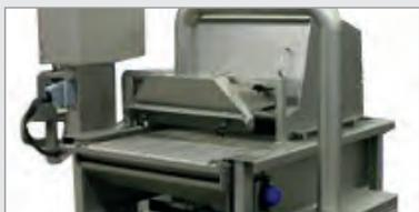
9. Zusätzlich kann ein **Eigelb-Sprüher** installiert werden. Optional mit Luftbürste zum Abblasen von überschüssiger Glasur.
