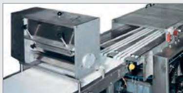
9a. Eine weitere Installationsoption ist eine **Streuereinheit**. Die Pies können mit verschiedenen Trockenbelägen belegt werden.
