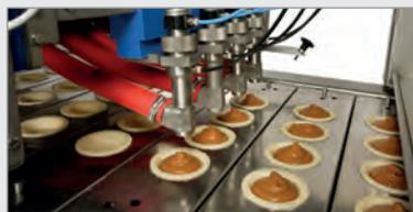
5. Rademaker bietet eine breite Palette von **Dosiergeräten** an, um ein noch breiteres Spektrum an Füllungen zu ermöglichen: flüssige und halbflüssige oder viskose Materialien mit oder ohne Fleisch- oder Obststücke.
