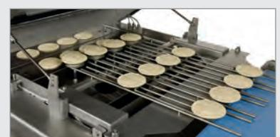
8. Das **Ausfuhrsystem** befördert die Pies vom Förderband zu den entsprechenden Paneelen. Es kann aber auch mit einer Vorrichtung zur Entladung auf Ofenbänder, Gefrieranlage-Zuführer oder Schalen geliefert werden.
