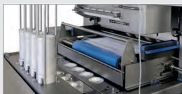
2. Der **Folienverteiler** ist mit einem Vakuumsystem ausgestattet, das sicherstellt, dass die Folie richtig platziert ist.
