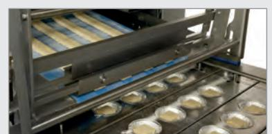
3. Teigverarbeitung: Der **Streifenzuführer** und die Schneidemaschine von Rademaker sorgen für ein äußerst genaues Teiggewicht.
