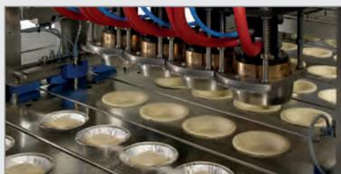
4. Die Teigblöcke werden durch eine **servo-gesteuerte Presse** ohne Ausschuss in die gewünschte Form gebracht. Der Blockierkopf ist **wasserbeheizt** und ermöglicht so einen präzisen und zuverlässigen Betrieb.
