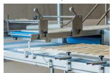
Eine Schneidemaschine schneidet das Teigband in regelmäßige rechteckige Bänder, die dann übereinander gestapelt werden. Dieses flexible symmetrische System trägt gleichmäßige und ungleichmäßige Schichten auf. Geeignet für weiche Teige ohne Beschränkungen hinsichtlich der Laminierbreite.
