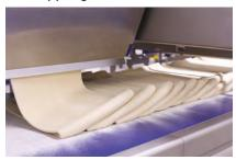
Das Teigband verläuft vertikal zwischen einem Führungssystem, das sich hin und her bewegt. Diese symmetrische Laminiermethode ist für weichen Teig ungeeignet und hat eine maximale Laminierbreite von 600 mm.
