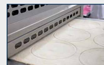
**4. Produktschneiden:** Schneiden von Produkten aus den Teigbändern. Mehrere Formen, Größen und Randpressungen sind möglich.
