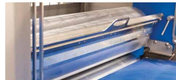
Um die Rollen der Reduzierstationen so sauber wie möglich zu halten, werden verschleißfeste Rollenabstreifer eingesetzt.
