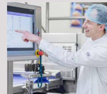
Besonderes Augenmerk wird auf die Benutzeroberfläche des 22-Zoll-Touchscreens gelegt. Seine Position kann mühelos an die bevorzugte Arbeitshöhe angepasst werden. Die Steuerungsplattform ermöglicht nahtlosen OMAC-basierten Datenaustausch mit angrenzenden Drittanbietersystemen. Fortschrittliche Datenverarbeitung befähigt zur Echtzeitüberwachung und Feinabstimmung der Anlageneffizienz.
