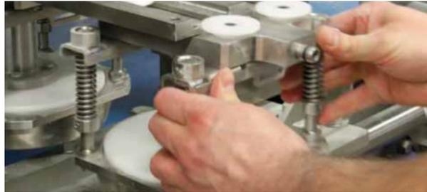
Mit dem Unique Fit Tooling werden ein effizienter, fehlerfreier Betrieb und Werkzeugwechsel sichergestellt. Dank der leichten und kompakten Werkzeuge ist die Handhabung und Demontage der Werkzeuge äußerst einfach und kann von einer Person durchgeführt werden.
