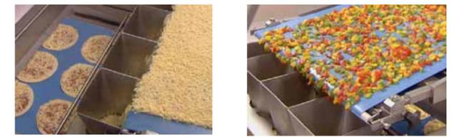
Produktspezifischer Trichtersatz für „indexierte“ Pizzabelegsysteme, bei denen der Rand der Pizza nicht bestreut wird. Dieses System benötigt kein Rezirkulationssystem. Wenn unterschiedliche Größen oder Formen belegt werden müssen, werden Wechselteile benötigt.
