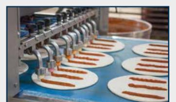
**6. Auftragen der Sauce:** Die Tomatensauce wird auf den Pizzaböden aufgetragen. Es stehen verschiedene Methoden zur Verfügung, wie beispielweise die Duschkopfauftragung und die Streifenauftragung.
