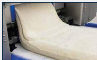
**1. Teigbandformer:** erzeugen homogene und spannungsfreie Teigbänder aller Art mit hervorragender Gewichtskontrolle bei höchster Qualität. Die Teigstruktur bleibt unberührt.
