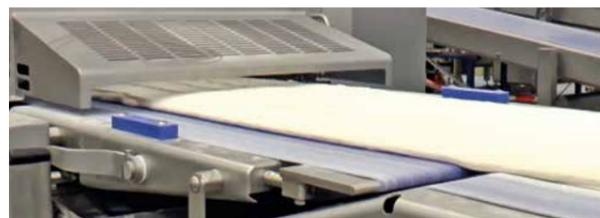
Eliminierung von Fallhöhen: Durch die Minimierung der Transporthöhe in der gesamten Produktionslinie ergibt sich ein stabiles und spannungsfreies Teigband.
