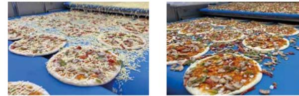
Dieses System gewährleistet eine flexible Produktgröße, da mehrere Pizzaformen und -größen auf demselben System ohne Wechselteile hergestellt werden können. Dieses System bietet höchste Leistung und zuverlässige Streugenaugkeit durch einen innovativen Algorithmus. Zur Rückführung des Streugutes ist ein Rezirkulationssystem integriert.
