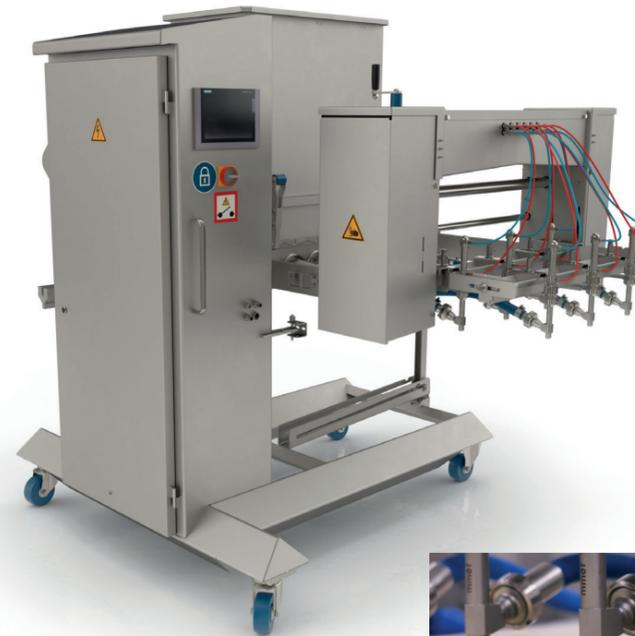
Unser Mohno Pump Depositor bietet eine breite Palette an Dosiermöglichkeiten. Er kann in Punkt-, diskontinuierlichen oder kontinuierlichen Streifen dosieren. Dieses System bietet eine hohe Ablagegenauigkeit durch die individuelle Mengensteuerung pro Reihe. Die Kombination aus Förderschnecke Die Kombination aus Schnecke und Mohno-Pumpe ermöglicht das Ablegen von Materialien, die Gemüse- und Fruchtstücke enthalten.
