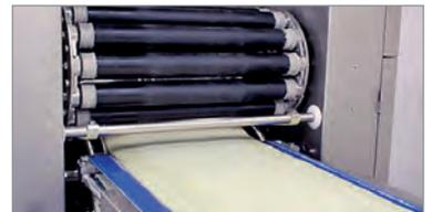
2. La primera reducción del espesor de la masa se realiza mediante un Quick reductor. Gracias a nuestros rodillos antiadherentes, podemos procesar tipos de masa con altos índices de hidratación.
