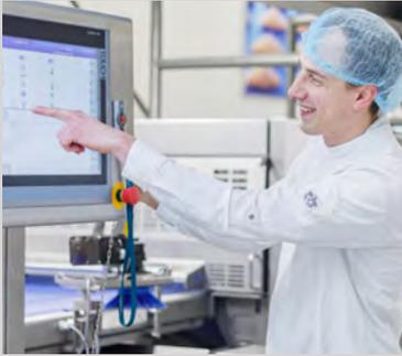
Se ha prestado especial atención a la interfaz de usuario de la pantalla táctil de 22 pulgadas. Su posición puede ajustarse sin esfuerzo a la altura de trabajo preferida. La plataforma de control facilita el intercambio de datos basado en OMAC con equipos vecinos de terceros. El procesamiento avanzado de datos permite supervisar y ajustar la eficiencia del equipo en tiempo real.
