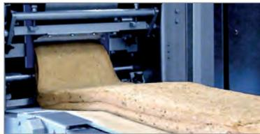
1. Preformado de la masa: genera una cinta de masa no tensada, de cualquier tipo, con un excelente control del peso y una calidad óptima.
