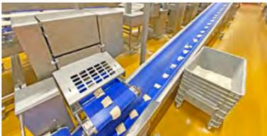
Opción: los recortes se transfieren directamente a la extrusora mediante un sistema de reciclaje en línea. No se pierde masa durante el proceso.
