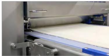
4. La banda de masa se reduce a su espesor final a medida que pasa por los rodillos de la(s) calibradora(s).
