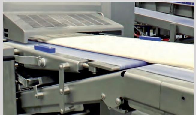
*Eliminación de las alturas de caída: al minimizar la altura de transporte en toda la línea de producción, conseguimos una lámina de masa estable y relajada.*
