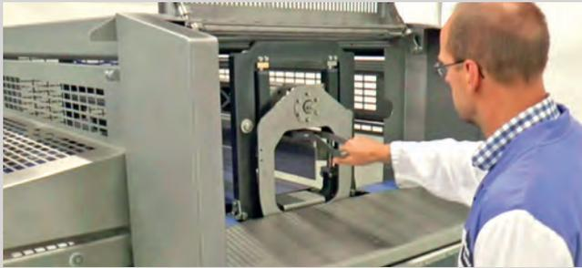
*El exclusivo software Fit Tooling facilita el uso y el cambio de herramientas. El utillaje, más ligero y compacto, hace que la manipulación y el desmontaje sean un juego de niños, y puede realizarlos una sola persona. No se necesita ningún otro dispositivo para ayudar al operador a cambiar las herramientas.*
