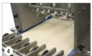
4 Нарезка полос & опрыскивание водой
