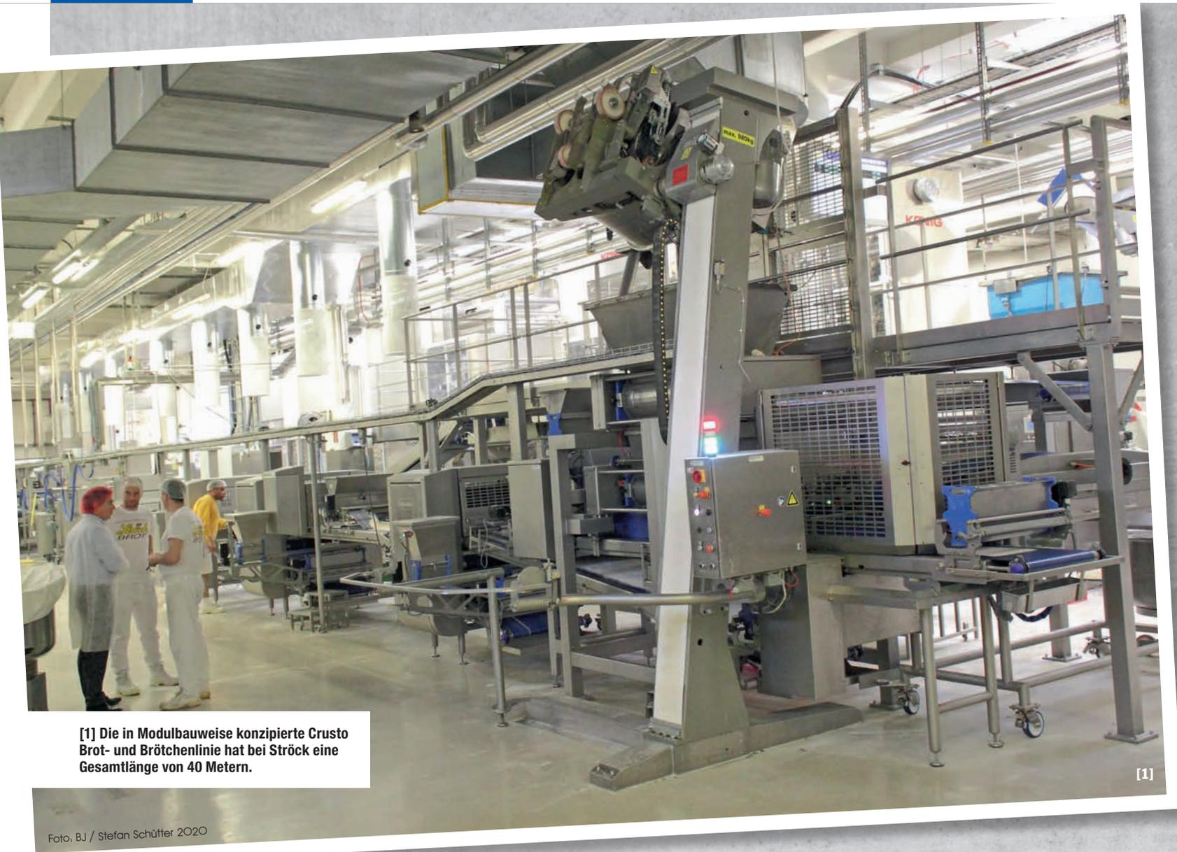
[1] Die in Modulbauweise konzipierte Crusto Brot- und Brötchenlinie hat bei Ströck eine Gesamtlänge von 40 Metern.
