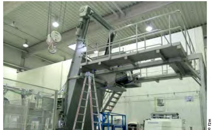
++ Über einen von DIOSNA gebauten Hebekipper wird der Teig über einen Trichter zur Weiterverarbeitung aufgegeben
