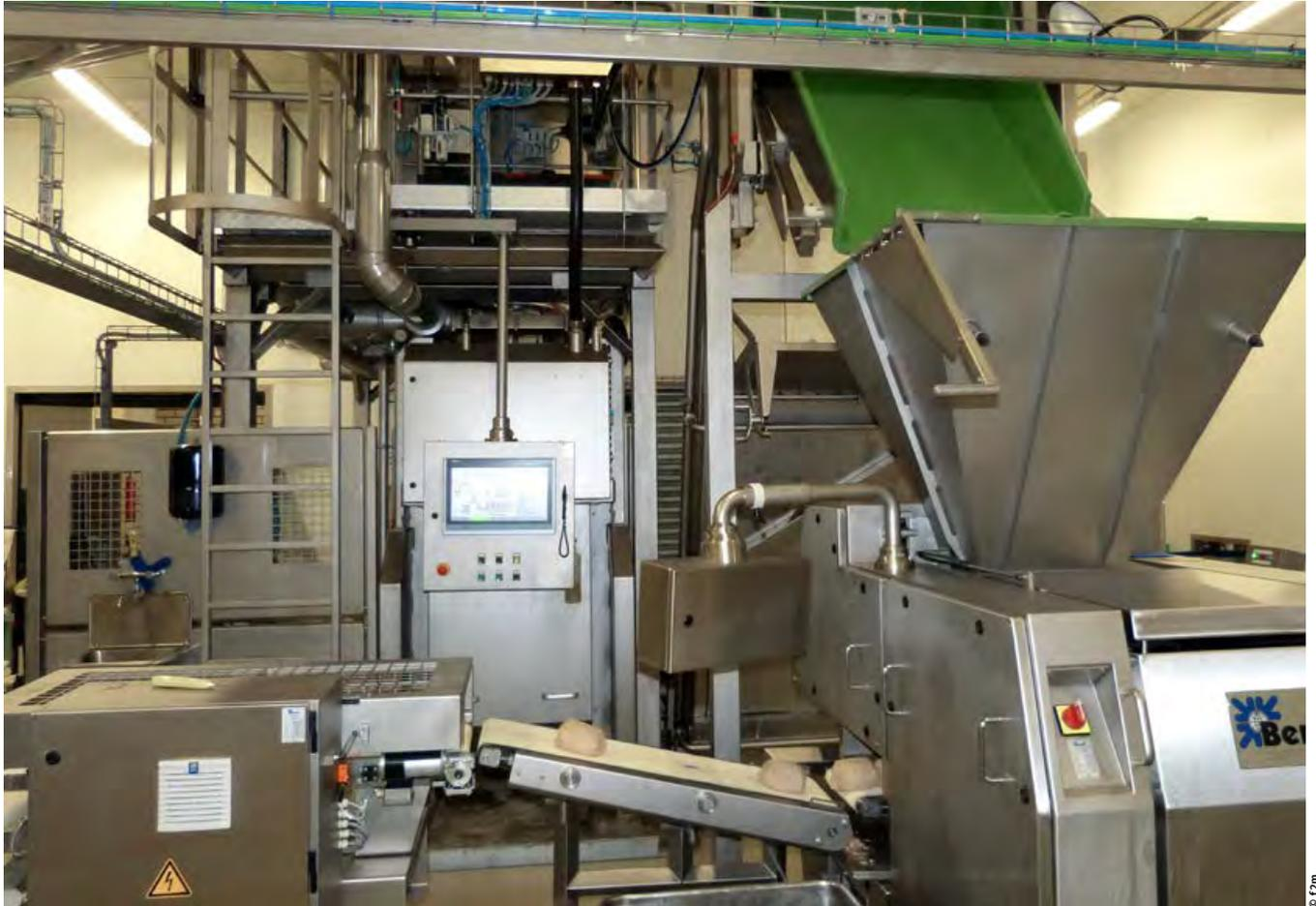
++ Bei der Bäckerei de Paauw wird der Weizenteig nach dem Kneten direkt über einen Hebekipper in einen Teigteiler portioniert
