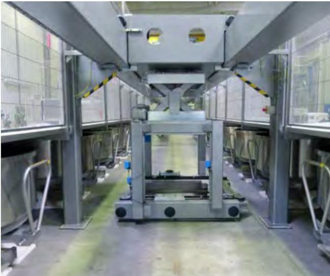
++ Zwei Roboter transportieren die insgesamt 36 Edelstahlbottiche innerhalb der Knetanlage zu den Knetern und in die Ruhepositionen
