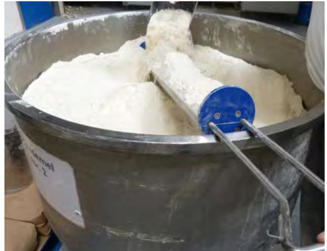
++ Um die Mehler nachzufüllen, lassen sich Mehl-Befüller herausziehen. Anschließend wird das Befüllgerät durch einfaches Hineinschieben über den Sicherheitskäfig über dem Mehler entleert
