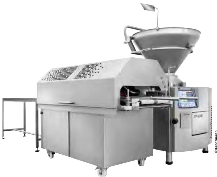
++ Das SE 443 mit dem VF 600 B zur Herstellung von Kastenbrot
