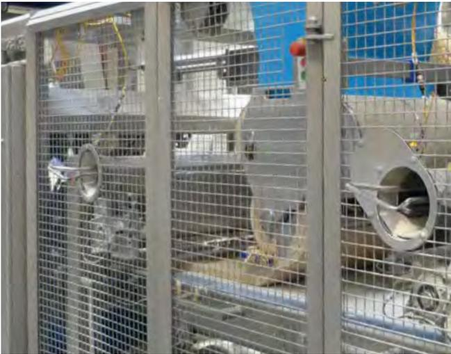
++ Ein Doppelsatellitenkopf nach dem Teigbandformer sorgt in jeder Menes-Anlage für ein praktisch spannungsfreies Teigband
