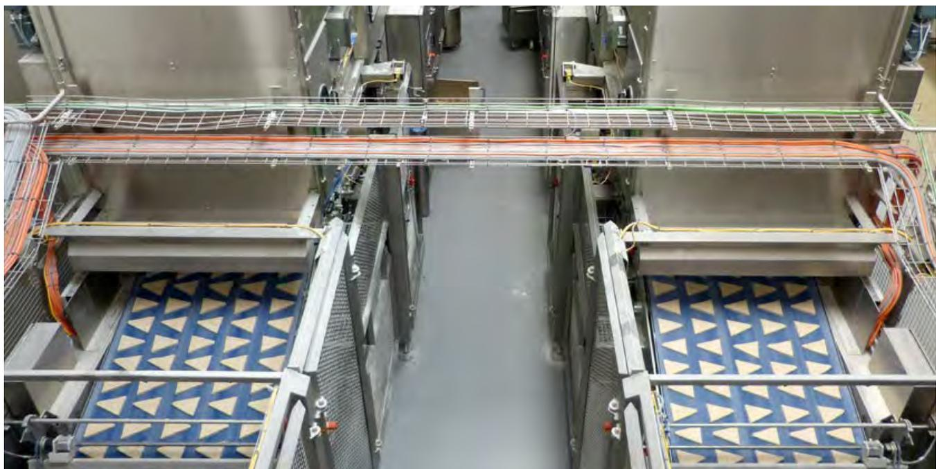
++ Bei der neuen Anlage wird zuerst ein Teigband erzeugt, welches sich nachfolgend auf zwei gespiegelte Anlagen aufteilt
