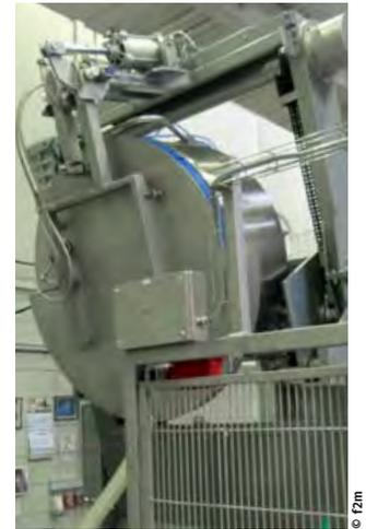
++ Sobald der Bottich in der Reinigungsposition ist, klappt ein Deckel auf den Kessel und die automatische Reinigung beginnt
