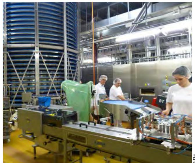
++ Die Stanztorten durchlaufen ebenfalls einen Ein-Etagen-Durchlaufofen. Hier zu sehen ist die automatische Verpackung
