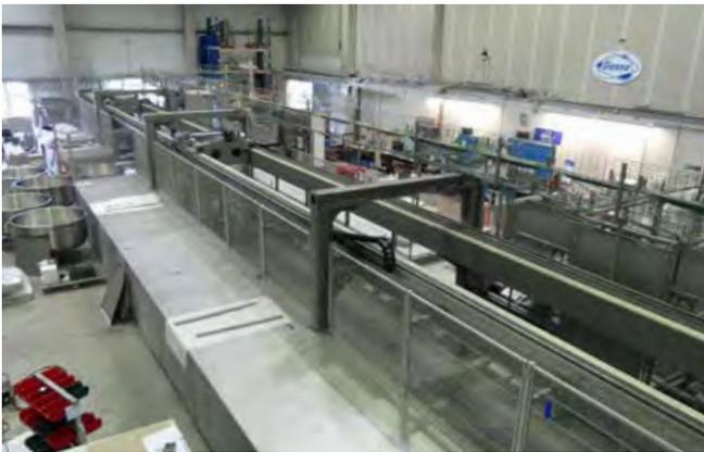
++ Das Transportsystem ist linear aufgebaut und zwei Roboter übernehmen den Transport zu den einzelnen Knet- und Ruhestationen
