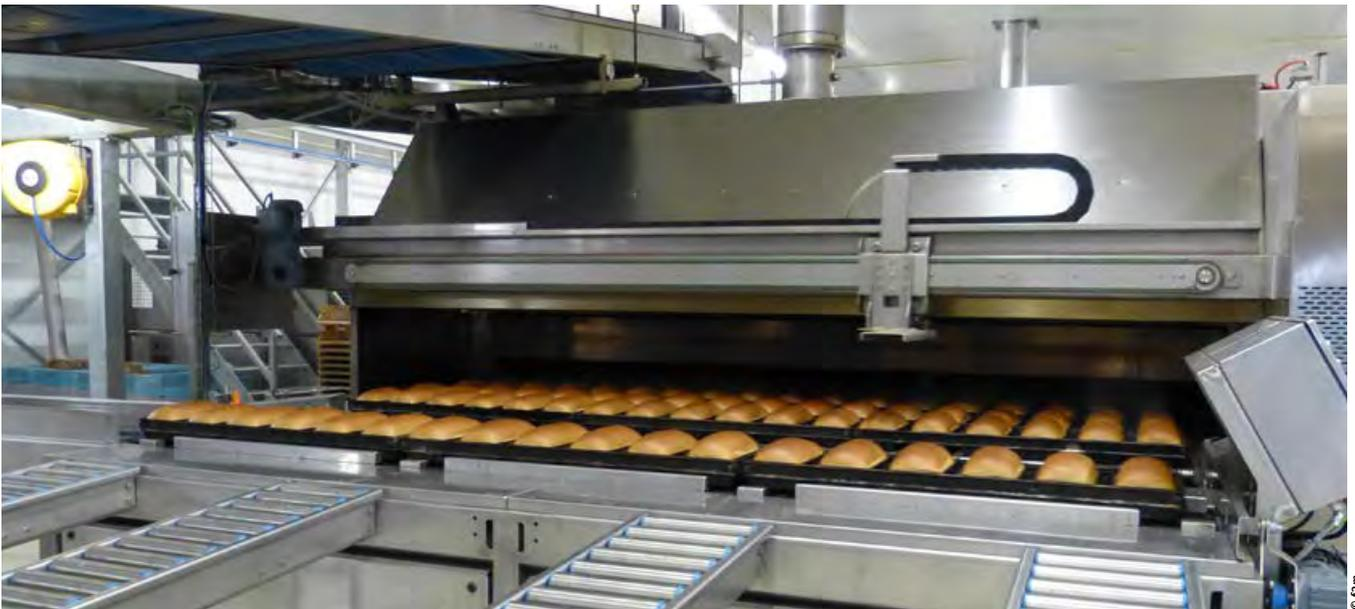
++ Gebacken wird in einem Ein-Etagen-Durchlaufofen von MCS
