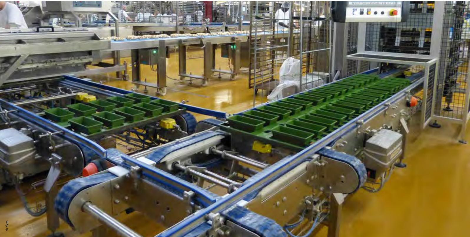
++ Flexibilität wird in der Produktion dadurch gewährleistet, dass alle Produkte in Blechen transportiert und gebacken werden. Große Blechpuffer sorgen für ständigen Nachschub
