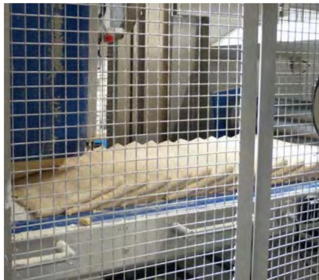
++ Durch das Laminieren des Teigbandes wird die Volumenausbeute und die Formstabilität der Backwaren unterstützt
