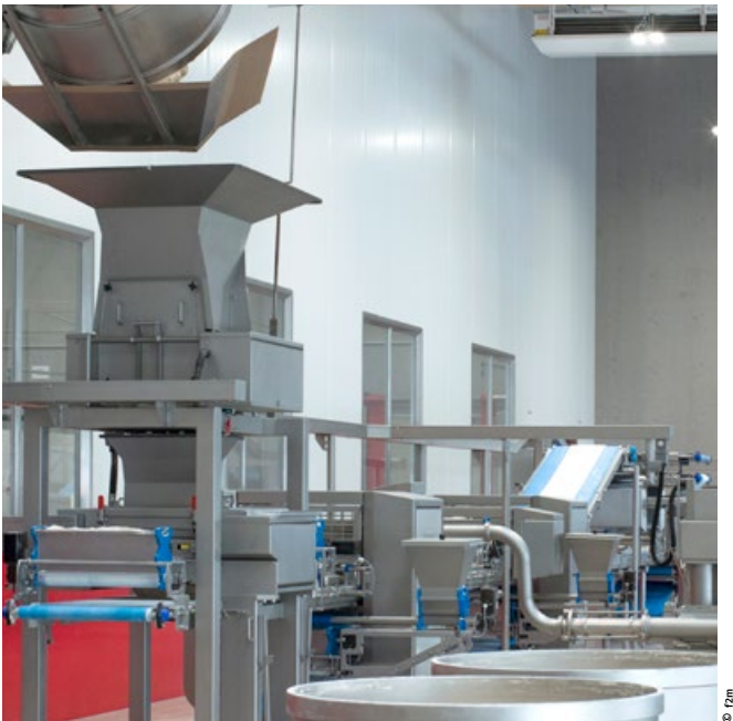
++ Die Teigchargen werden im Chunker deponiert, bevor sie vom Rademaker Low Stress Sheeting System (LSS) verarbeitet werden
