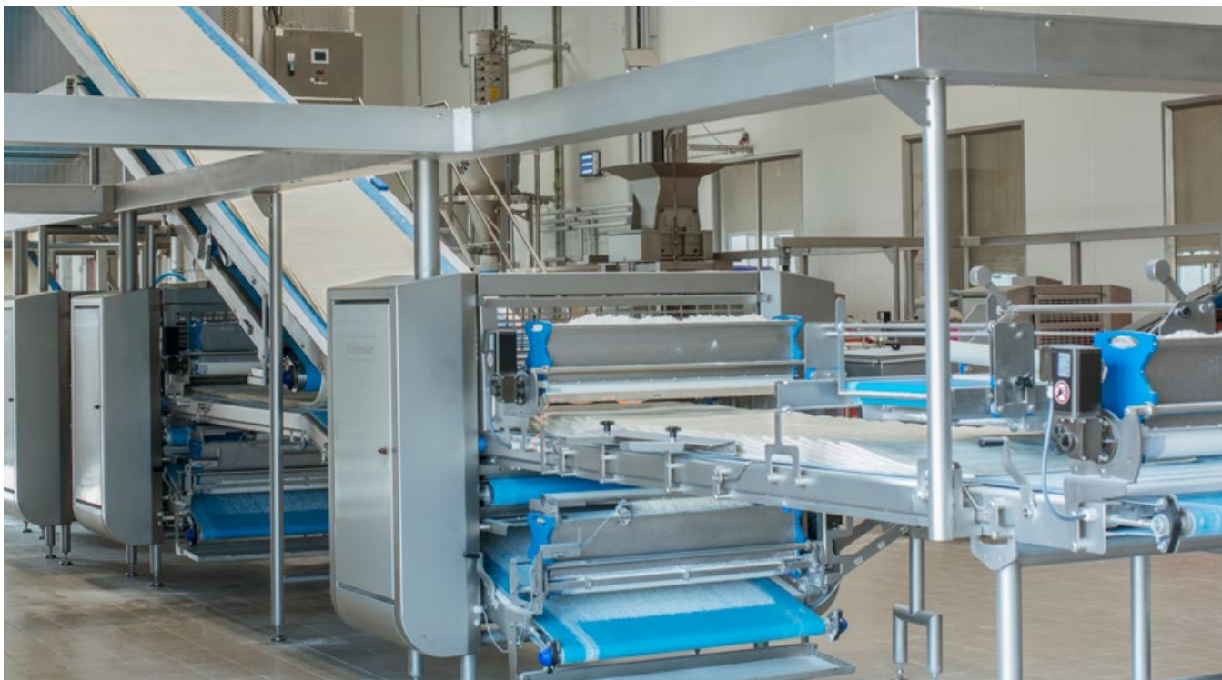
++ Dieses fertige laminierte Teigband durchläuft nach der Reduzierung eine Kühl- und Ruhephase in Rademakers Cooling & Resting System
