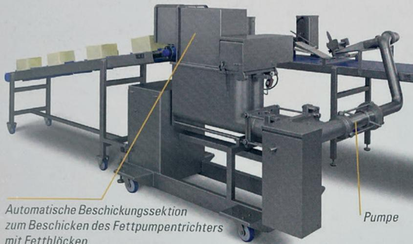
Automatische Beschickungssektion zum Beschicken des Fettpumpentrichters mit Fettblöcken.
