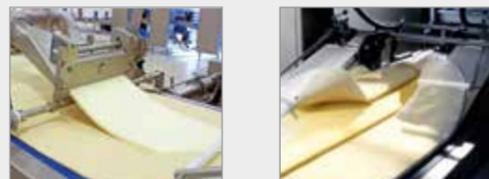
La pompe à gras transforme des blocs de beurre, de margarine ou de graisses saturées (sans graisse trans) en une bande de matière grasse continue. La pompe est mobile et entièrement démontable pour un nettoyage rapide et facile. Après avoir placé la bande de matière grasse sur la pâte, la pâte et la matière grasse sont combinées.
