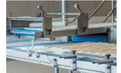
Une guillotine découpe la bande de pâte en pâtons rectangulaires réguliers qui sont ensuite empilés les uns sur les autres. Ce système symétrique flexible prépare un nombre de couches paires ou impaires. Adapté aux pâtes molles et sans restrictions quant à la largeur de laminage.
