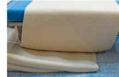
Le tapis et la bande de pâte se déplacent d'avant en arrière au-dessus du convoyeur de transport suivant. C'est un système de laminage asymétrique adapté aux pâtes molles et sans restrictions quant à la largeur de laminage.
