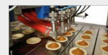
5. Rademaker fournit un large éventail de **doseuses** permettant d'élargir encore davantage la gamme des garnitures : matériaux liquides, semi-liquides ou visqueux, avec ou sans particules de viande ou de fruits.
