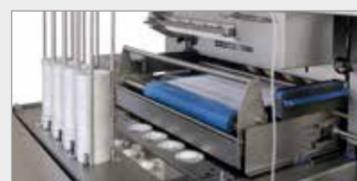
2. Le **dépilleur de moules** est doté d'un système d'aspiration garantissant leur positionnement correct.
