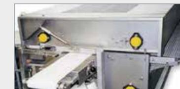
9b. Afin d'optimiser le chargement du four ou du surgélateur, une unité de triage « **marshalling** » peut être utilisée. Cette unité vous permet d'augmenter le nombre de rangs dans la largeur sur les convoyeurs suivants.
