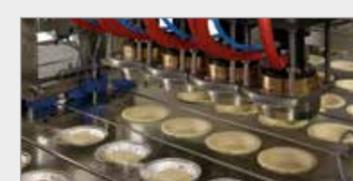
4. Les pâtons sont foncés à la forme souhaitée sans aucune rognure par une **presse à servocommande**. La tête de fonçage est chauffée à l'eau pour un fonctionnement précis et fiable.
