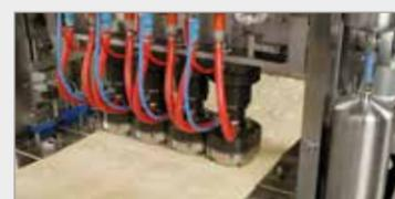
7. L'unité de **sertissage à servocommande** scelle le couvercle au fond. La décoration du sertissage peut être conçue selon vos spécifications. La permutation facile des têtes de sertissage vous permet de créer une large gamme de décorations. La tête de sertissage est également chauffée à l'eau.
