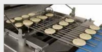
8. Le **système d'évacuation** transfère les fonds de pâte du convoyeur vers des panneaux dédiés, mais il peut également être livré avec une configuration de déchargement vers une bande de four, l'entrée d'un surgélateur ou des plaques.
