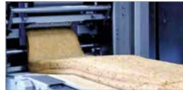
2. Extrusion de la pâte à pain : production de bandes de pâte non stressées de tout type avec un excellent contrôle du poids et de la plus haute qualité. La structure de la pâte n'est pas affectée, car la pâte est manipulée avec délicatesse. Plusieurs solutions sont disponibles en fonction du type de pâte.
