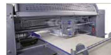
4. Calibreur transversal : permet d'ajuster uniformément la largeur et l'épaisseur de la bande de pâte.
