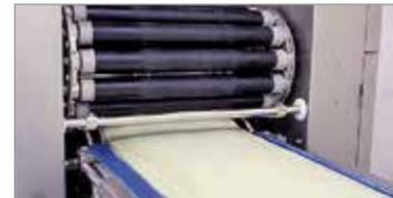
3. Quick réducteur : la première réduction de l'épaisseur de l'abaisse est réalisée par un Quick réducteur. Grâce à nos rouleaux non adhérents, nous sommes en mesure de traiter des types de pâtes à taux d'hydratation élevé.
