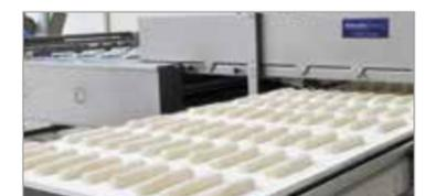
Nos systèmes de chargement de plaques sont capables de charger avec précision les produits sur les plaques de cuisson, peelboards, attelages, moules de cuisson ou les tapis de transport. Nous avons développé plusieurs systèmes pour fournir une solution à chaque situation spécifique.
