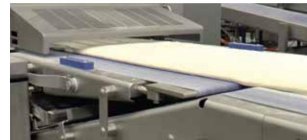
*Élimination des hauteurs de chute : en minimisant la hauteur de transport sur toute la ligne de production, il en résulte un ruban de pâte stable et détendu.*
